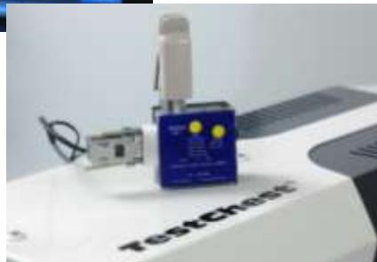
Опция пульсоксиметрического датчика, с генерацией сигнала SpO<sub>2</sub> для имитации измерения сатурации крови
